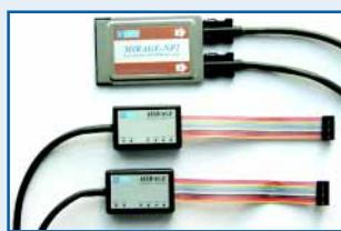
ра, обеспечивает работу с напряжениями питания устройств ЦОС в диапазоне 0,5...5 В, программную установку частоты JTAG-интерфейса в диапазоне 0,5...30 МГц с шагом 0,1 МГц, а также совершенно новые встроенные возможности измерения напряжения питания и частоты JTAG/MPSD-интерфейса отлаживаемого устройства ЦОС.
